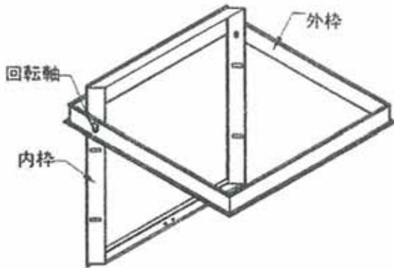
2. ボード材を内枠に入れて、ボード押え金具で押えながらビスで確実にボード押え金具を固定してください。
